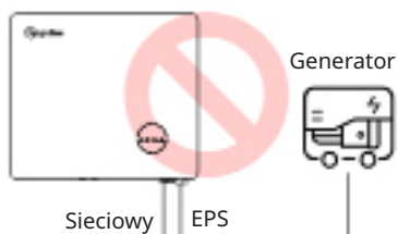
Ani EPS ani port sieciowy nie mogą być podłączone bezpośrednio do generatora.
