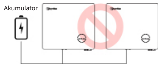
Jeden akumulator nie może być podłączony do wielu falowników.
