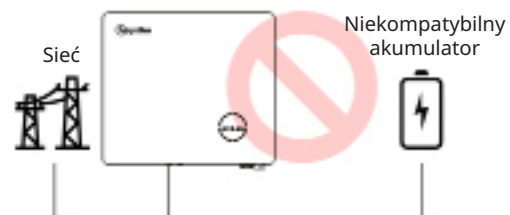
Do portu akumulatora nie można podłączyć niekompatybilnego akumulatora.
