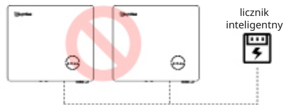
Jeden licznik nie może być podłączony do wielu falowników, a różne CT nie mogą być podłączone do tego samego przewodu liniowego.
