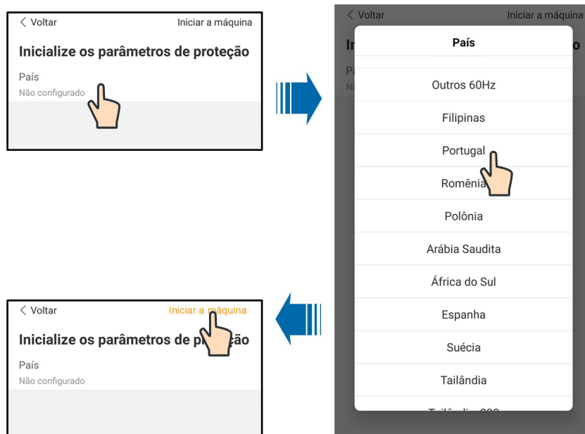
Figura 7-4 Parâmetro de proteção de inicialização
